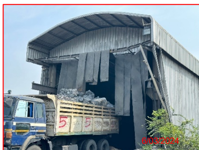
(22) การปิดคลุมหลังคาถังรับหิน และปากโม่หิน
