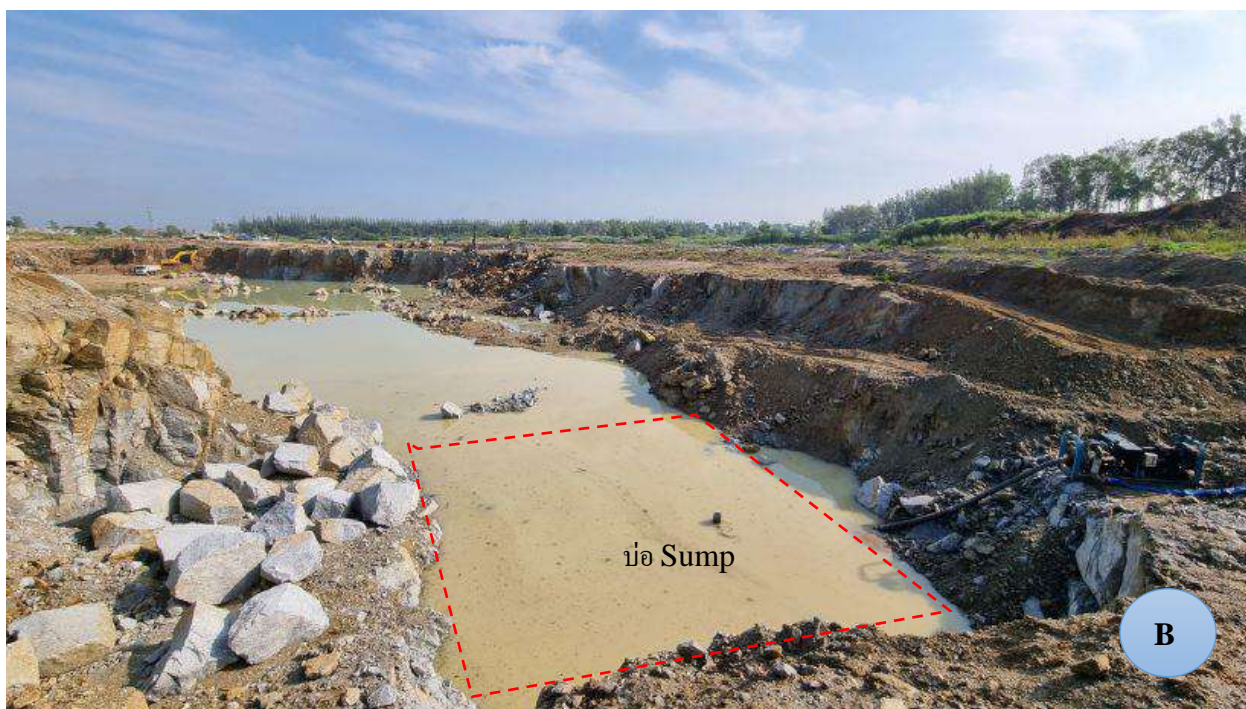
ภาพที่ 3 บ่อรองรับน้ำในขุมเหมือง (บ่อ Sump)
