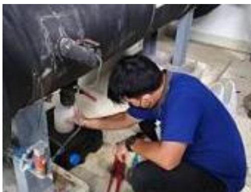
ภาพที่ 3.5.4-1 ตำแหน่งและวิธีการเก็บตัวอย่างน้ำจากห้องฝักเย้น
