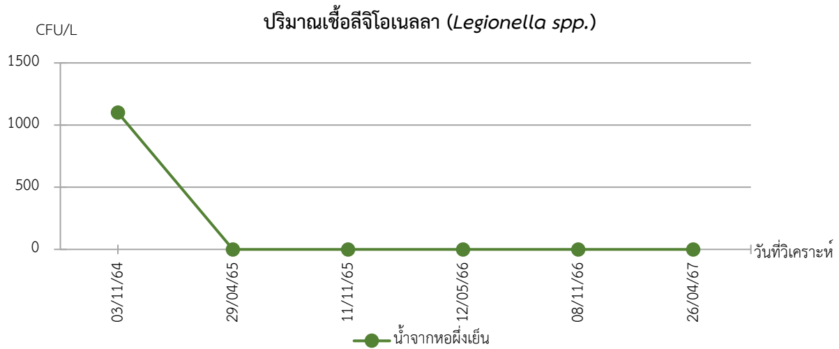
ภาพที่ 3.5.4-2 (ต่อ) กราฟเปรียบเทียบผลการตรวจวิเคราะห์คุณภาพน้ำจากหอผึ่งเย็น ในปี 2565-ปัจจุบัน
