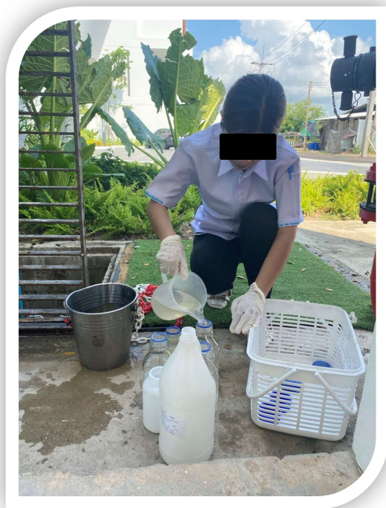
ภาพที่ 33 แสดงภาพเก็บตัวอย่างน้ำทิ้งหลังบำบัด
