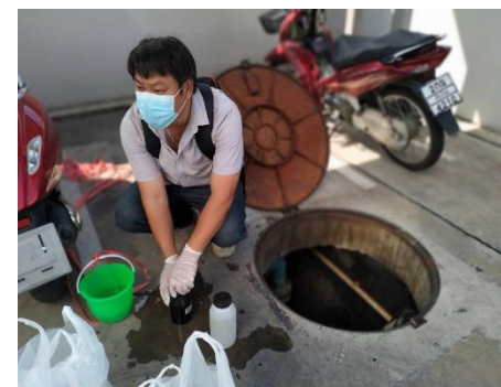
ภาพที่ 3-2 เก็บตัวอย่างคุณภาพน้ำทิ้งบริเวณน้ำจากบ่อกักน้ำสุดท้ายก่อนระบายออกระบบระบายน้ำทิ้งสาธารณะ
