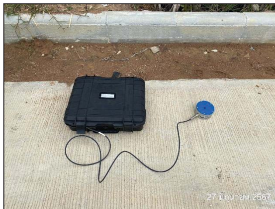
รูปที่ 4.5 การตรวจวัดความสั่นสะเทือน บริเวณ ภายในพื้นที่ก่อสร้างโครงการ (ระยะที่ 1 บริเวณด้านทิศใต้ของโครงการติดกับหมู่บ้านปณาลี บ้านนา)
