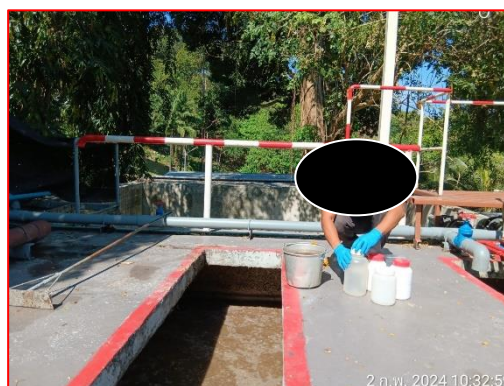
รูปที่ 3.4 การเก็บตัวอย่างน้ำบ่อเติมอากาศ
