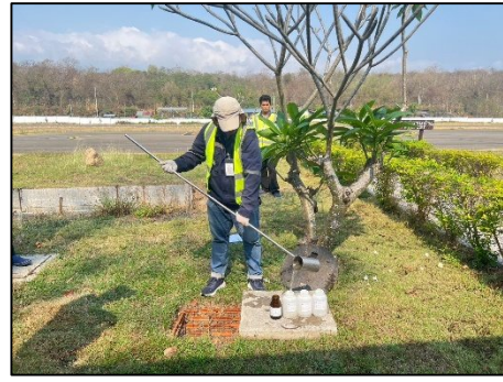
บ่อบำบัดน้ำทิ้งก่อนเข้าระบบบำบัดน้ำเสียของอาคารที่พักผู้โดยสาร
