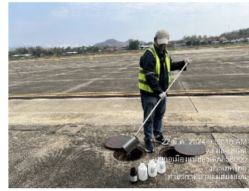
บ่อกักน้ำหลังผ่านระบบบำบัดน้ำเสียสำเร็จรูปของอาคารผู้โดยสารขาเข้า จุดที่ 3
