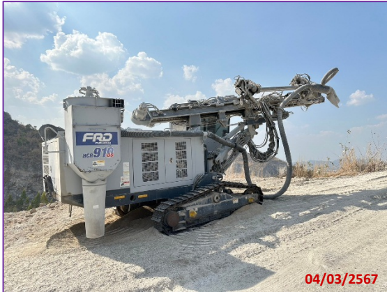
ภาพที่ 2-8 เครื่องเจาะระเบิดที่มีถังดักฝุ่นบริเวณหัวเจาะ
