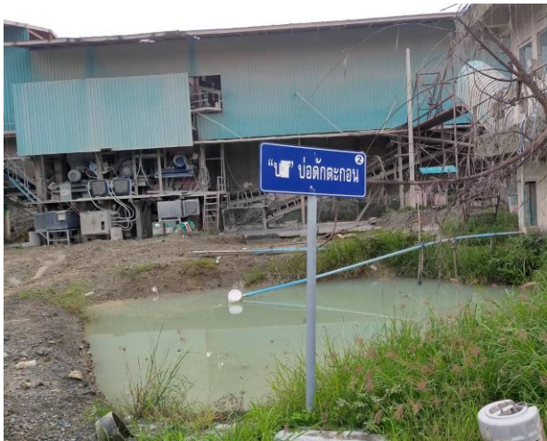
รูปที่ 2-9ข. (ต่อ) แนวระบายน้ำสู่บ่อดักตะกอน บริเวณโรงโม่หิน
