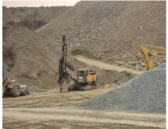
รูปที่ 2-6 เครื่องเจาะหลุมระเบิดที่มีอุปกรณ์ดักฝุ่น
