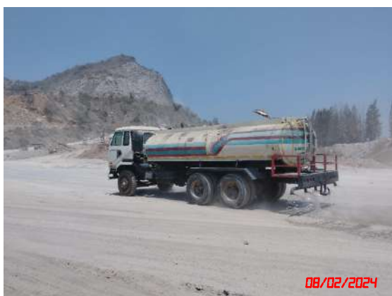
รูปที่ 20 การฉีดพรมน้ำบริเวณเส้นทางขนส่งแร่
