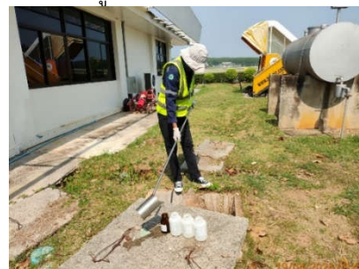
บ่อกักหลังผ่านระบบบำบัดน้ำเสียของอาคารที่พักผู้โดยสาร
