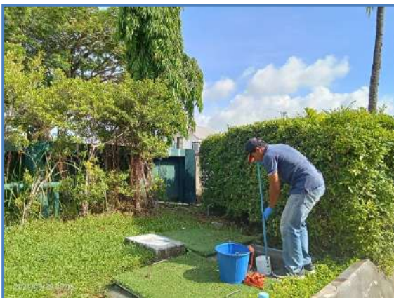
รูปที่ 3.2 แสดงการเก็บตัวอย่างน้ำผ่านระบบบำบัด (บริเวณถังพักน้ำสำหรับนำกลับมาใช้ใหม่)
