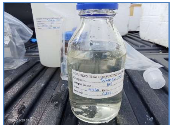
รูปที่ 3.2 แสดงการเก็บตัวอย่างน้ำผ่านระบบบำบัด (บริเวณถังพักน้ำสำหรับนำกลับมาใช้ใหม่)
