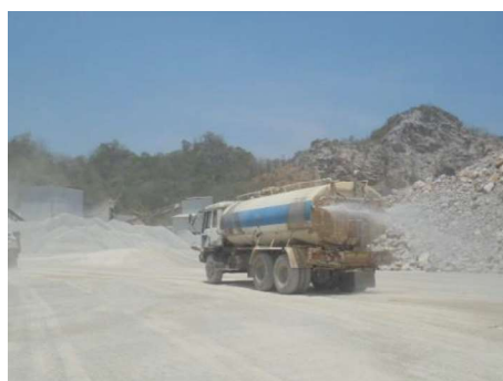
รูปที่ 2-24: การฉีดพรมน้ำบริเวณหน้าเหมือง
