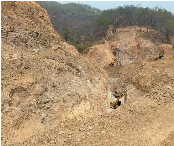
รูปที่ 2-21 ลักษณะหน้าเหมืองที่อยู่ในช่วงขั้นตอนการปรับแต่งให้เป็นไปตามที่แผนผังโครงการกำหนด
