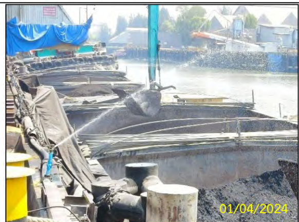
มีการติดตั้งระบบฉีดพ่นน้ำให้ความชื้นกับถ่านหิน
