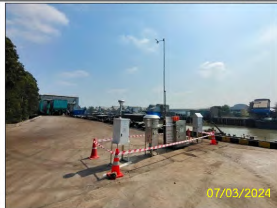
ป) ตัวอย่างการเก็บตัวอย่างคุณภาพอากาศในบรรยากาศภายในโครงการ
