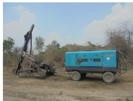
รูปที่ 2-28: เครื่องเจาะกระแทกหินใหญ่
