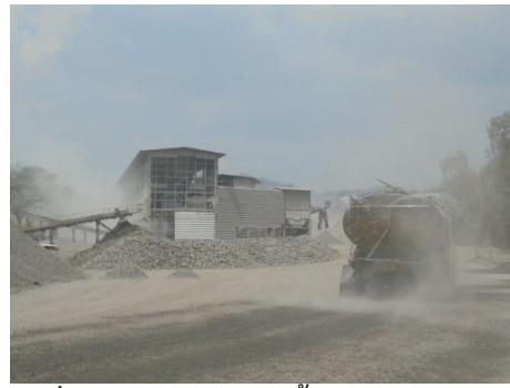
รูปที่ 2-16: การฉีดพรมน้ำบริเวณโรงโม่หิน
