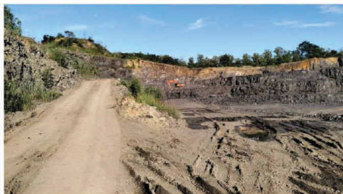
รูปที่ 2: การทำเหมืองแบบขั้นบันได
