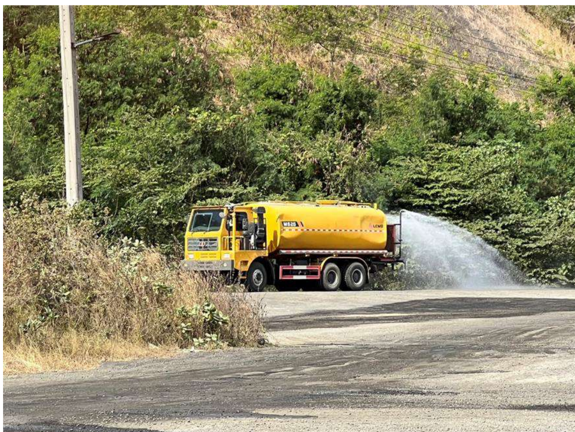
รูปที่ 6 รถน้ำใช้ในการรด/สเปรย์ถนนลำเลียงหินป้องกันฝุ่นและใช้เพื่อสเปรย์ในระบบฝุ่นโรงโม่
