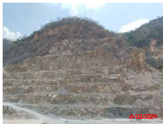
พื้นที่ปรับความลาดชันหลังจากผ่านการทำเหมือง
