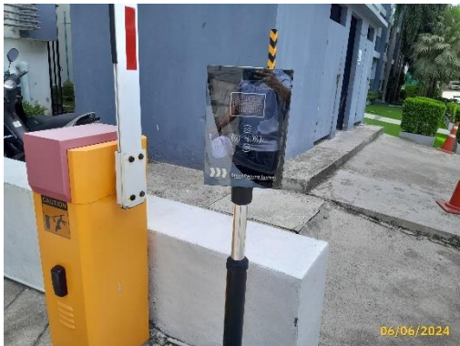
เครื่องอ่านอุปกรณ์แพร่คลื่นสัญญาณ
