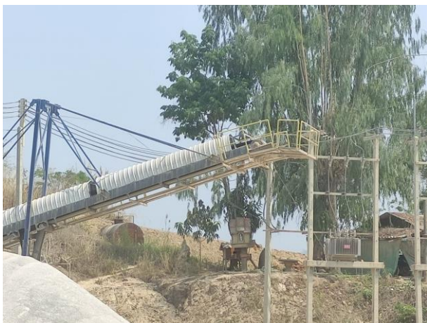
รูปที่ 2-7 (ต่อ) การปิดคลุมสายพานลำเลียง
