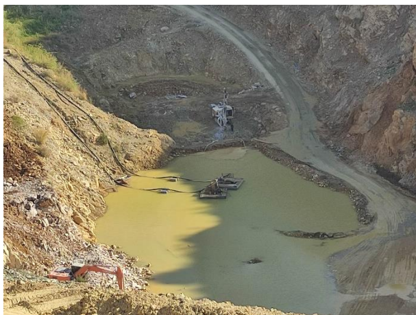
รูปที่ 2-18 บ่อรับน้ำบริเวณพื้นที่ต่ำสุดของบ่อเหมือง (ภาพกิจกรรมล่าสุด)
