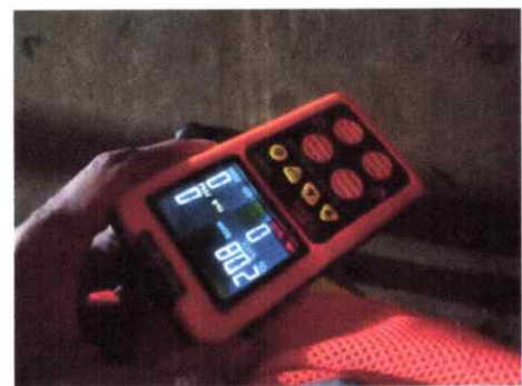
การวัด-เติมอากาศก่อนลงถัง
