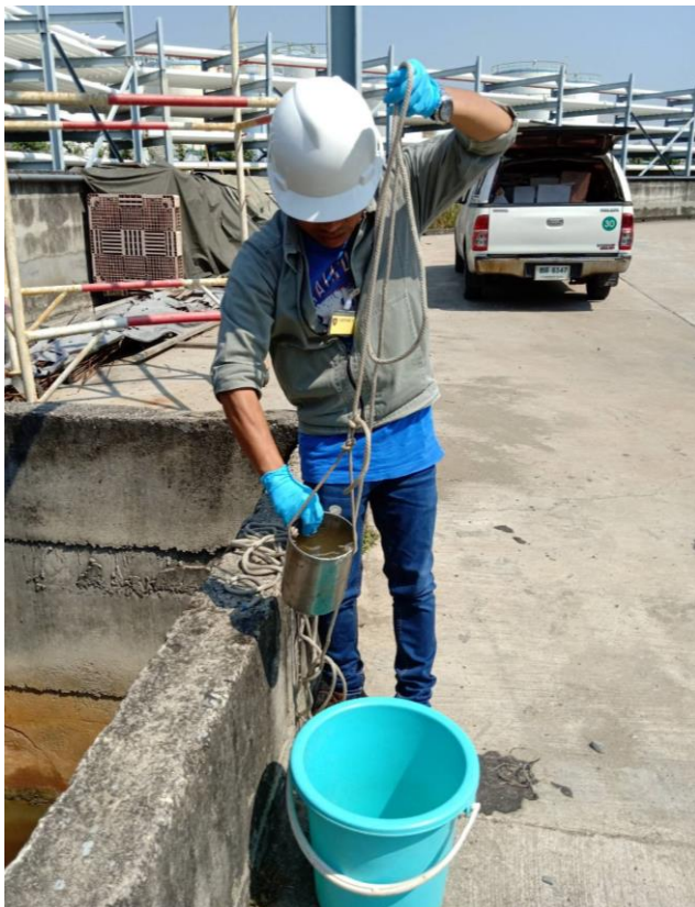
ภาพที่ 3-18 อุปกรณ์และวิธีการเก็บตัวอย่างน้ำทิ้ง
