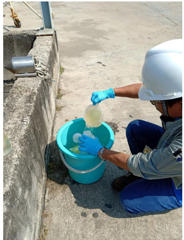
ภาพที่ 3-18 อุปกรณ์และวิธีการเก็บตัวอย่างน้ำทิ้ง
