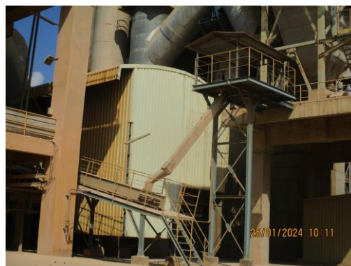
รูปที่ 4 ระบบลำเลียงฝุ่นแบบปิดมิดชิด
