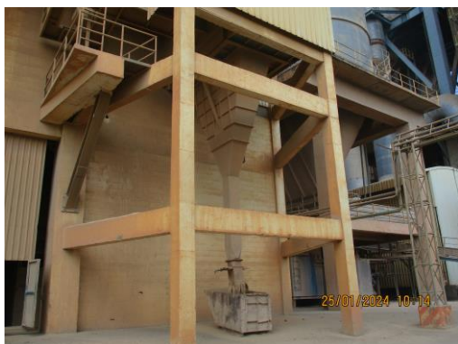
รูปที่ 4 ระบบลำเลียงฝุ่นแบบปิดมิดชิด
