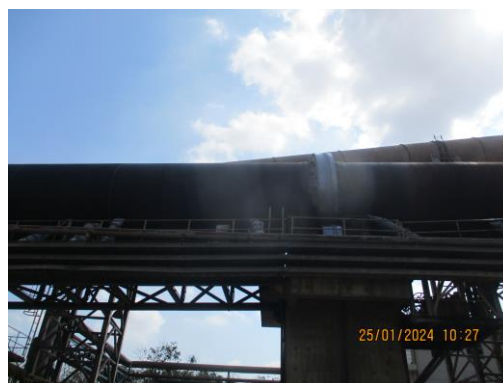
รูปที่ 24 เตาเผา Rotary Kiln
