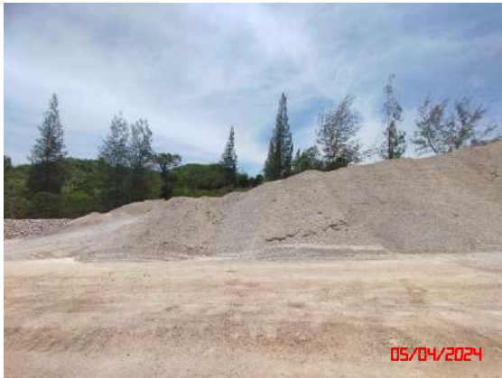
ลานเก็บกองแร่ที่เป็นลานหินบดอัดแน่น
