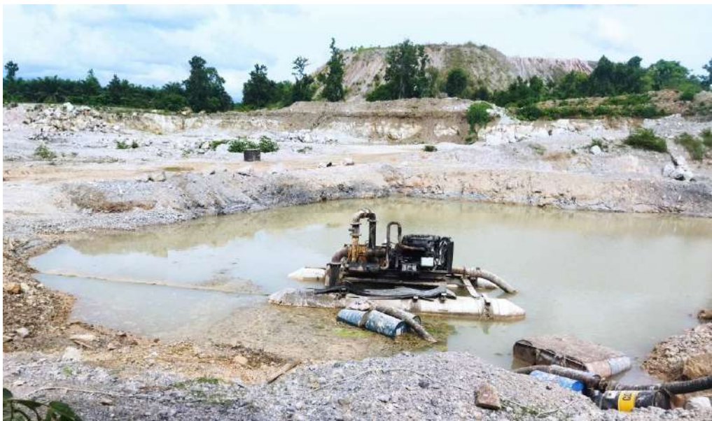
ภาพที่ 7 มีระบบสูบน้ำเพื่อลดปริมาณน้ำในเหมือง
