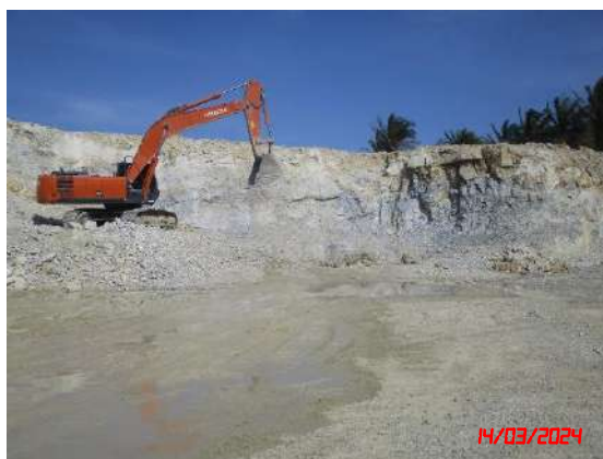
รูปที่ 28 การเก็บกวาดก่อนแร่บริเวณหน้างานระเบิด
