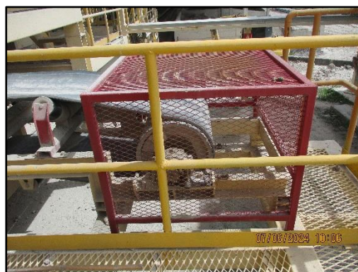
ภาพที่ 2.30 ตัวอย่างสายพานระบบปิด บริเวณที่มีเครื่องจักรเคลื่อนไหว
