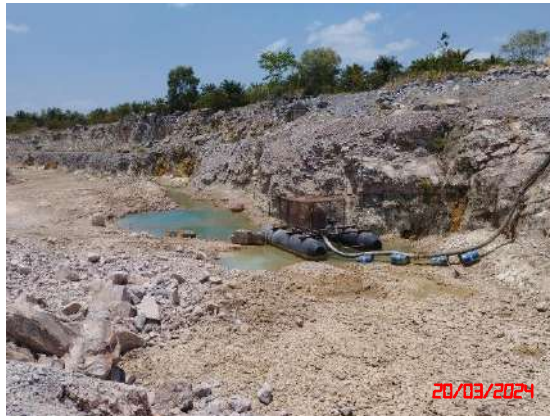
รูปที่ 29 บั้มสูบน้ำ
