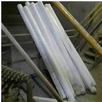
รูปที่ 9 การเปลี่ยนและตรวจสอบถุงกรอง
