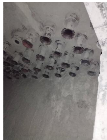
รูปที่ 9 การเปลี่ยนและตรวจสอบถุงกรอง
