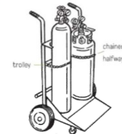
ตัวอย่างภาพการขนย้ายและติดตั้งอุปกรณ์งานตัดและงานเชื่อม
