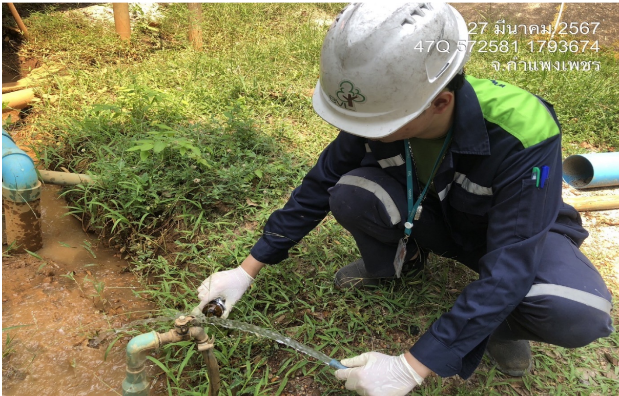
รูปที่ 3.4.4-2 ตรวจวัดคุณภาพน้ำใต้ดิน วัดมูจลินท์ (กระโดนเตี้ย)
