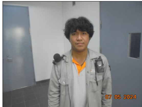
รูปที่ 3.17 การตรวจวัดระดับเสียงสะสมแบบติดที่ตัวบุคคล (Noise Dose)
