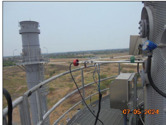
รูปที่ 3.1 การเก็บตัวอย่างคุณภาพอากาศในปล่องระบาย บริเวณ ปล่อง HRSG 21
