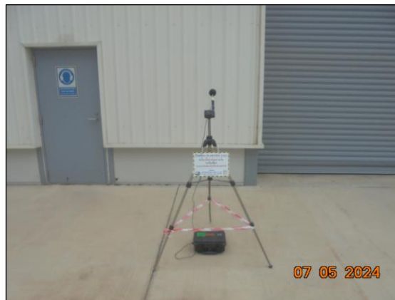
รูปที่ 3.14 การตรวจวัดระดับเสียงในพื้นที่ทำงาน บริเวณ Stem Turbine Generator
