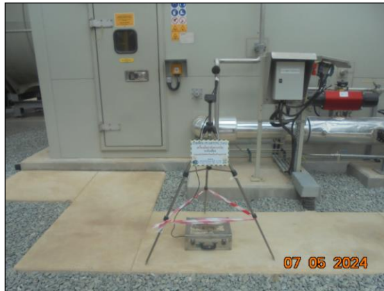
รูปที่ 3.13 การตรวจวัดระดับเสียงในพื้นที่ทำงาน บริเวณ Gas Turbine Generator
