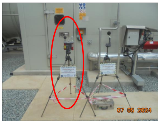
รูปที่ 3.21 การตรวจวัดระดับความร้อนในพื้นที่ทำงาน บริเวณ Gas Turbine Generator
