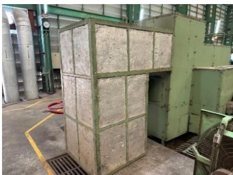
ภาพที่ 2.2-23 อุปกรณ์ปิดครอบเครื่องจักรที่มีเสียงดัง
