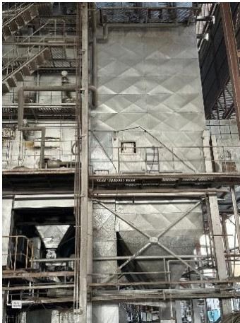
ภาพที่ 2.2-5 อุปกรณ์ดักฝุ่นแบบ Multi Cyclone
