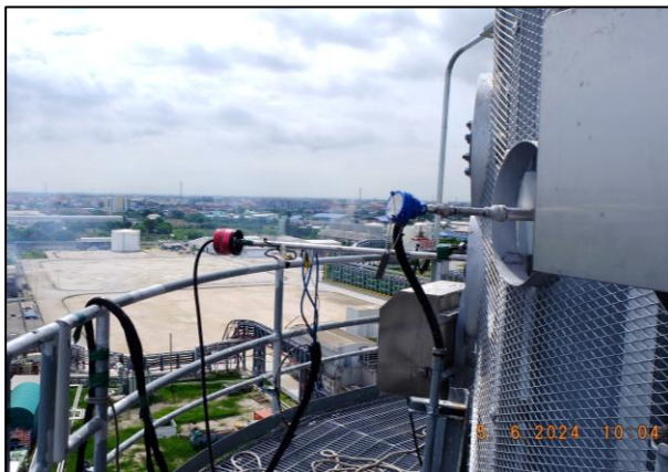
รูปที่ 3-2 การเก็บตัวอย่างคุณภาพอากาศในปล่องระบาย บริเวณ HRSG22
