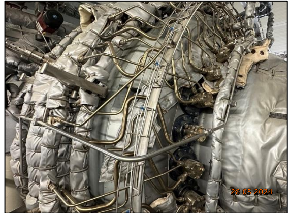
รูปที่ 2-2 ระบบหัวฉีดเผาไหม้แบบ Dry Low NO x (DLN)
