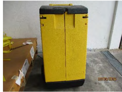
ภาพที่ 2.2-47 อุปกรณ์ควบคุมการหนีสารเคมีหกั่วไหล
