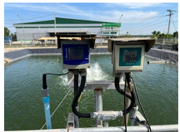
รูปที่ 2-5.2 (2) อุปกรณ์ตรวจวัดน้ำแบบ Online monitoring
