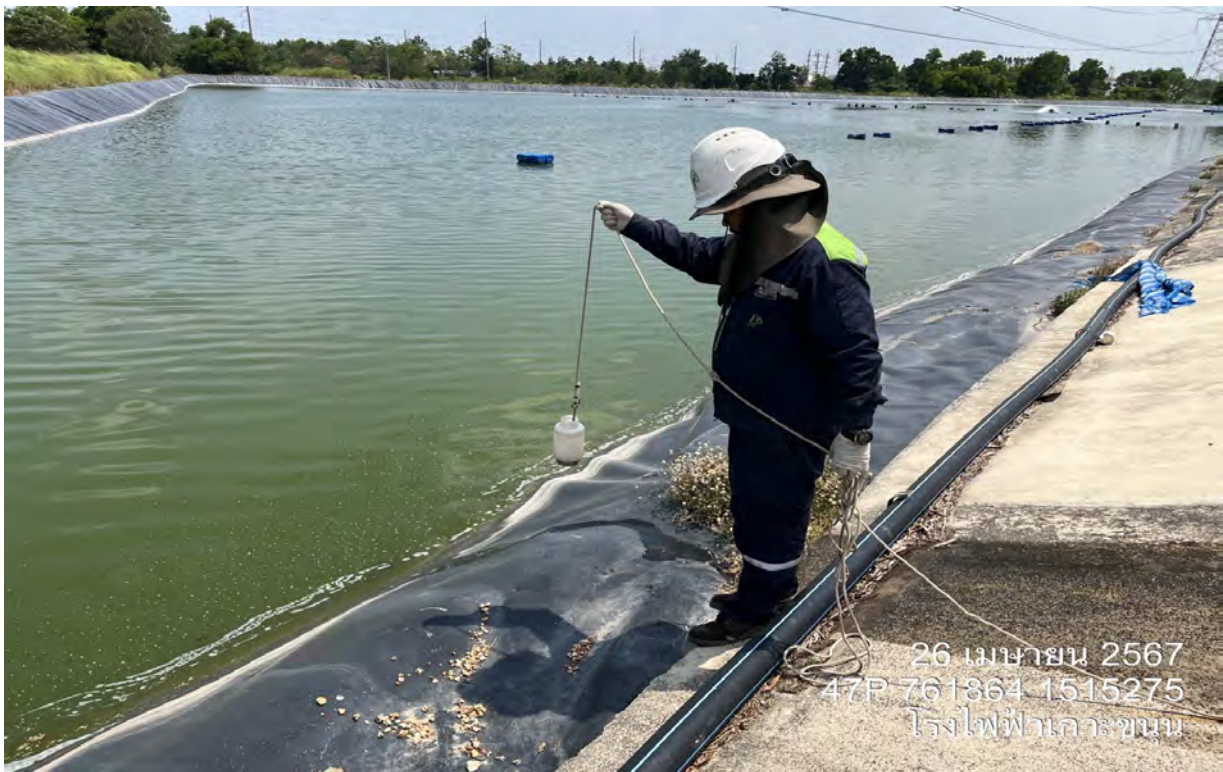
รูปที่ 3.4.4.1-2 การตรวจวัดคุณภาพน้ำ บริเวณบ่อพักน้ำทิ้ง 2
