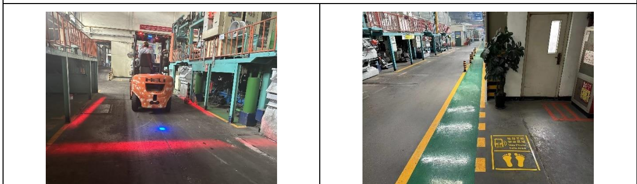
รูปที่ 29 ไฟเตือนรถฟอร์คลิฟท์
