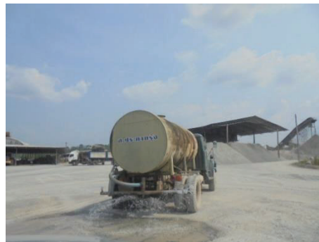
รูปที่ 2-25: การฉีดพรมน้ำบริเวณเส้นทางขนส่งแร่
