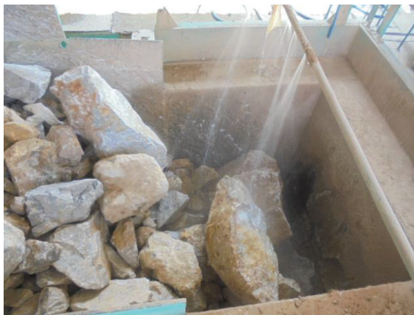
รูปที่ 2-14: การฉีดสเปรย์น้ำบริเวณโรงโม่
