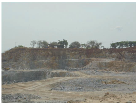
รูปที่ 2-38: การทำเหมืองแบบขั้นบันได
