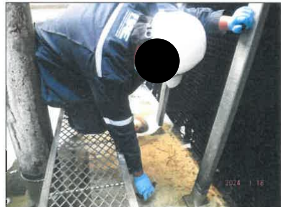
การเก็บตัวอย่างน้ำจากอ่างรองรับ (Cooling Tower)
