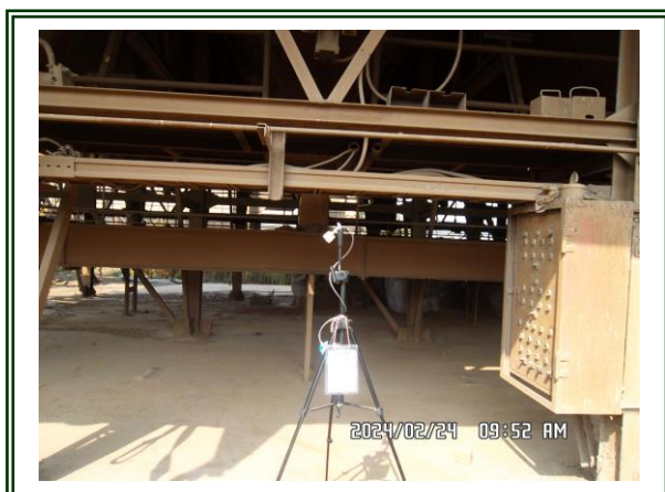
รูปที่ 4.2-37 แสดงจุดตรวจวัดคุณภาพอากาศในพื้นที่ทำงาน ฝุ่นที่ได้จากระบบดักฝุ่น ตรวจวัดในวันที่ 24 กุมภาพันธ์ 2567
