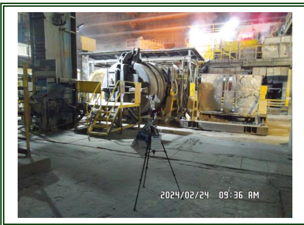
รูปที่ 4.2-36 แสดงจุดตรวจวัดคุณภาพอากาศในพื้นที่ทำงาน บริเวณห่างจากเตาหลอมด้านหน้าเหล็กประมาณ 10 เมตร ตรวจวัดในวันที่ 24 กุมภาพันธ์ และ 18 พฤษภาคม 2567
