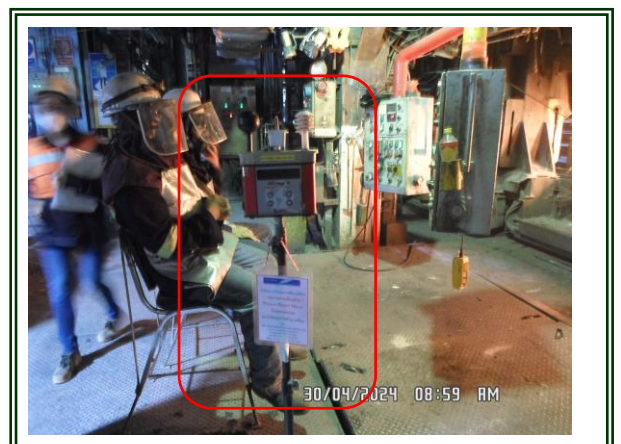
รูปที่ 4.2-44 แสดงจุดตรวจวัดระดับความร้อนในการทำงาน บริเวณห้อง CCM Cast น้ำเหล็ก ตรวจวัดในวันที่ 30 เมษายน 2567
