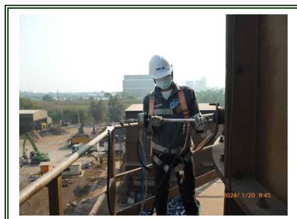
รูปที่ 4.2-31 แสดงจุดตรวจวัดคุณภาพอากาศที่ระบายออกจากปล่อง Canopy Hood (Outlet) ตรวจวัดในวันที่ 20 มกราคม และ 19 เมษายน 2567
