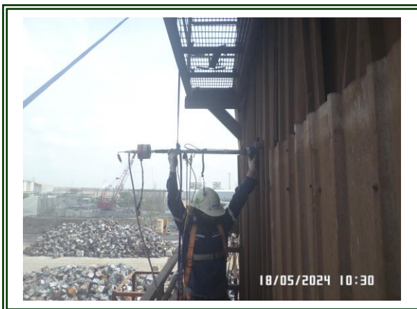
รูปที่ 4.2-33 แสดงจุดตรวจวัดคุณภาพอากาศที่ระบายออกจากปล่อง (Bag House (Outlet) ตรวจวัดในวันที่ 18 พฤษภาคม และ 10 มิถุนายน 2567
