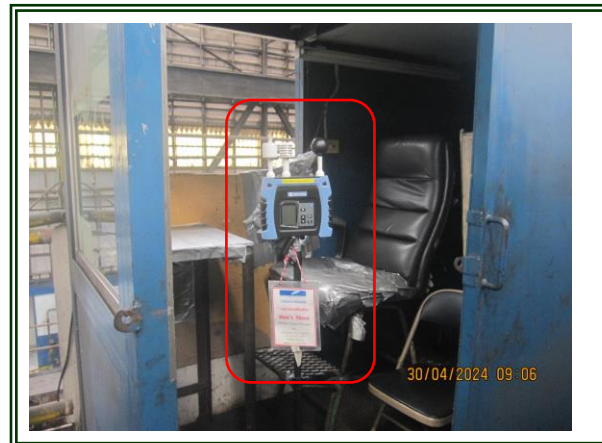
รูปที่ 4.2-41 แสดงจุดตรวจวัดระดับความร้อนในการทำงาน บริเวณควบคุม Turn Foaming Head ตรวจวัดในวันที่ 30 เมษายน 2567
