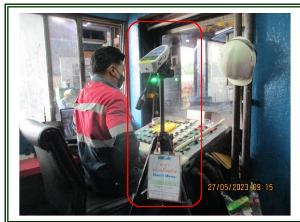
รูปที่ 4.2-53 แสดงจุดตรวจวัดระดับเสียงในพื้นที่ทำงาน บริเวณห้องควบคุมเครื่องมัด Coil ตรวจวัดในวันที่ 27 พฤษภาคม 2566
