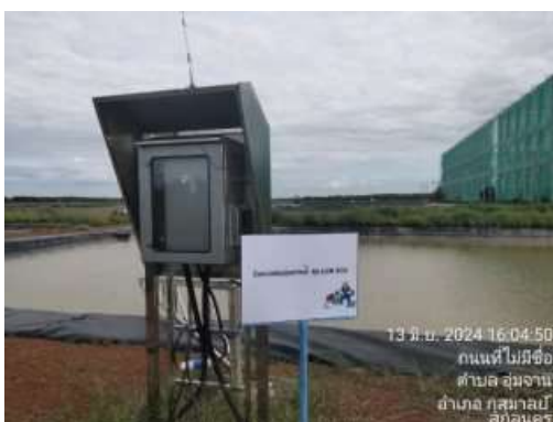
รูปที่ 2-43 เครื่องตรวจสอบคุณภาพน้ำเสียแบบอัตโนมัติ (ระบบบำบัดน้ำเสียความสกปรกต่ำ)
