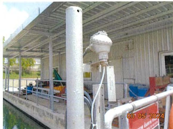
ภาพที่ 2.2-19 เครื่องวัดอุณหภูมิต่ออัตโนมัติ
