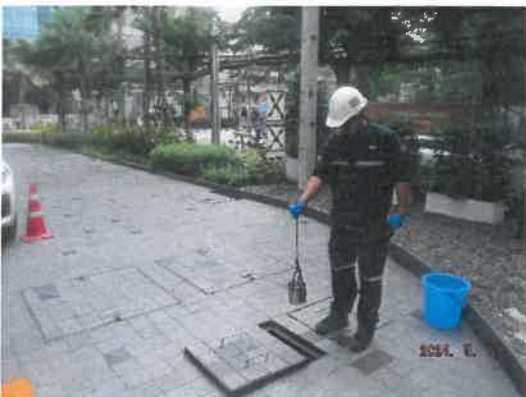
รูปที่ 3-3 การติดตามตรวจสอบคุณภาพน้ำทิ้ง บริเวณออกน้ำสุดท้ายของระบบระบายน้ำ
