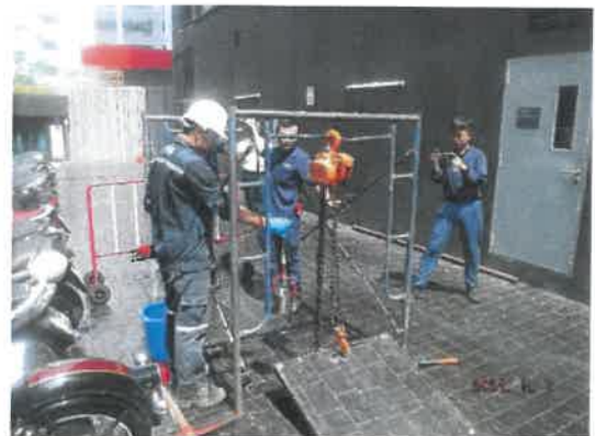
รูปที่ 3-2 การติดตามตรวจสอบคุณภาพน้ำทิ้ง บริเวณน้ำทิ้งหลังผ่านระบบบำบัดน้ำเสีย
