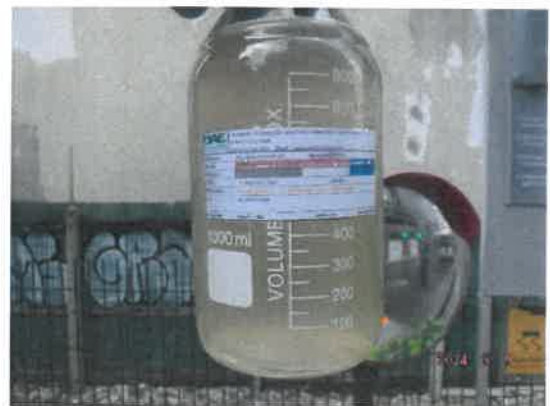
รูปที่ 3-3 การติดตามตรวจสอบคุณภาพน้ำทิ้ง บริเวณออกน้ำสุดท้ายของระบบระบายน้ำ
