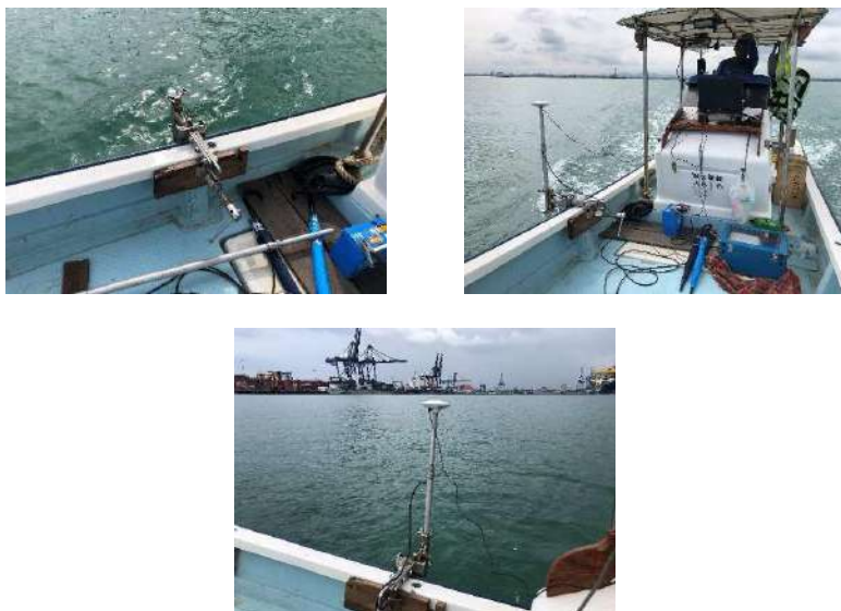
รูปที่ 5-6 การติดตั้งอุปกรณ์สำรวจในเรือสำรวจ
