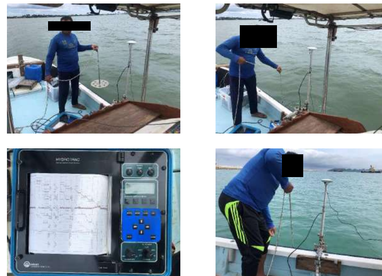
รูปที่ 5-7 การตรวจสอบความถูกต้องของเครื่องหยั่งน้ำ
