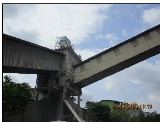
ภาพที่ 2.13 ระบบสายพานลำเลียงวัตถุดิบและเชื้อเพลิงเป็นระบบปิด
