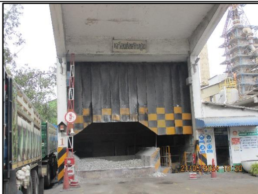
ภาพที่ 2.40 อ่างรับวัตถุที่มีม่านยางป้องกันการฟุ้งกระจายของฝุ่นละออง
